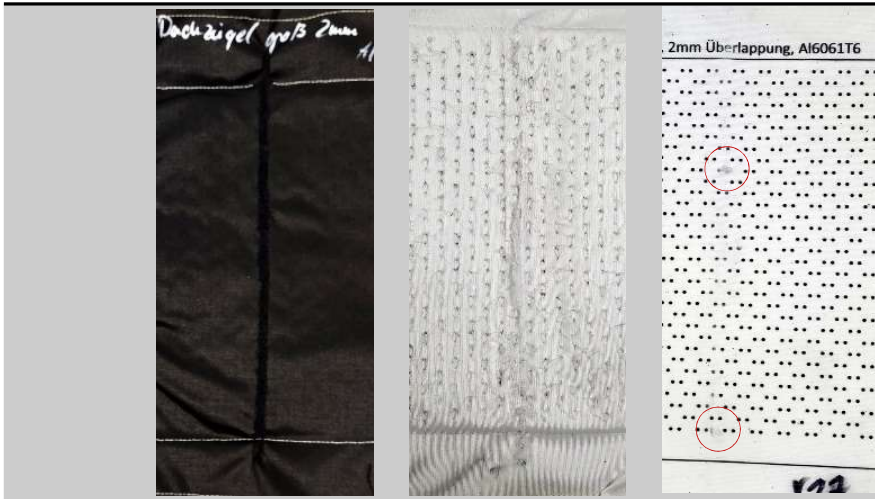
V17: Ovale Aluminiumplättchen + wasserfeste Abdeckung; Punktstrahldüse; 500 bar
