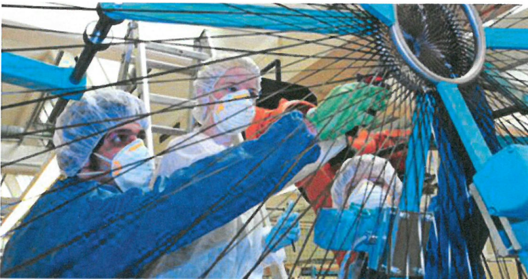
Ravand Ghomeshi (li.) mit Kollegen beim Flechten von Carbonfasern am ITV Denkendorf
