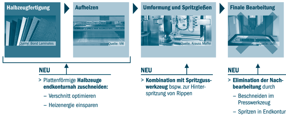
Abbildung 27: Möglicher voll industrialisierter Prozess der Organoblech-Umformung
