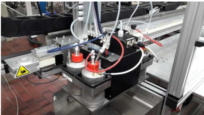
Abbildung 1: Chromojet-Druckkopf mit Bypass-Technologie
