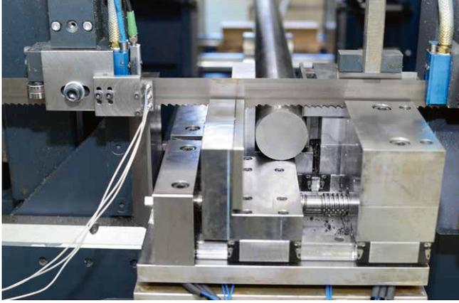
Industrie 4.0: Intelligente Anpassung der Sägebandspannung durch Prozessüberwachung und -regelung
