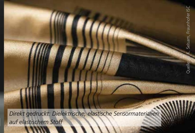
Direkt gedruckt: Dielektrische, elastische Sensormaterialien auf elastischem Stoff
