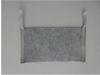
Abbildung 2: Mittels Klebevlieses kontaktierte Spannungszuführungselektroden einer Heizfläche
