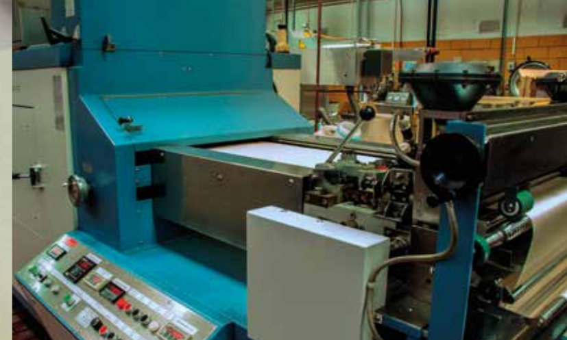
Fertigung eines Textils zur PDI am Spann- Trocken- und Fixierrahmen
