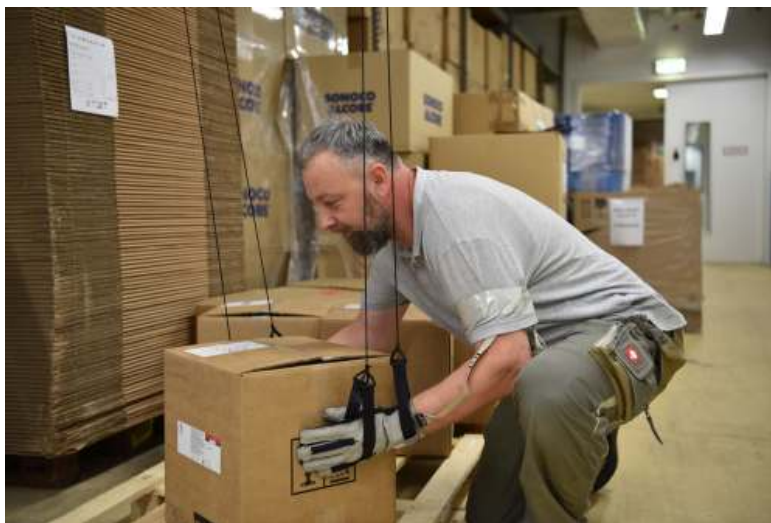
Schwere Lasten bewegen ohne körperliche Belastung mit SensHand. Foto: DITF
