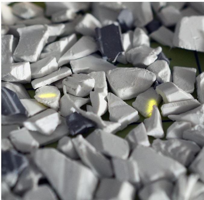
Mit den Fluoreszenz-Partikeln von Polysecure markiertes PVC- Mahlgut – leuchtendes Mahl gut wird von nicht leuchtendem oder unterschiedlich leuchtendem Mahl gut getrennt bzw. sortiert. Foto: © Polysecure GmbH
