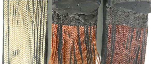
Haftung von Polyamid 6.6 an Kautschuk: ohne Haftvermittler (links) mit RFL-Dip (Mitte) mit HMF-Dip (rechts)
