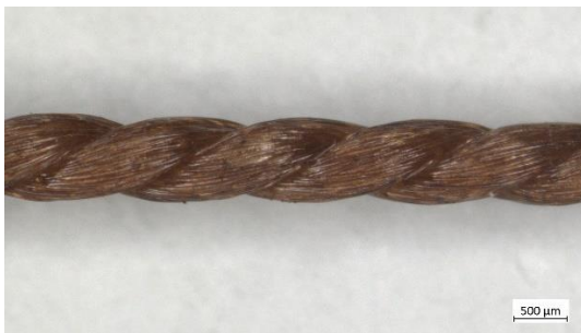
PA6.6-Garn mit Haftvermittler aus HMF (Makroskop-Aufnahme)
