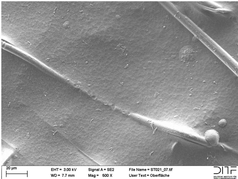
*Bild: rasterelektronenmikroskopische Aufnahme der Membran*
