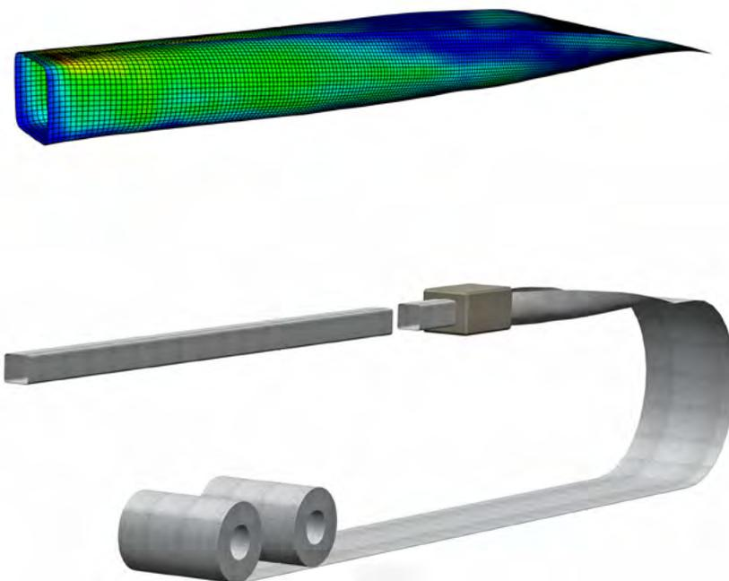
Scherwinkelanalyse der Umformung (oben) / Prinzip der Umformung (unten) (Foto: ITM/TU Dresden)
