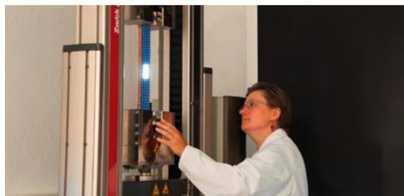
Gewebe mit LED im Dehn- und Stauchtest: TITV-Mitarbeiterin Sandra Haase im neuen Smart Textiles-Prüflabor (Foto: TITV)
