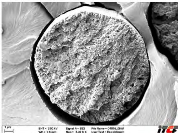
Rasterelektronenmikroskopische Aufnahme einer Chitin-Faser (Foto: DITF)
