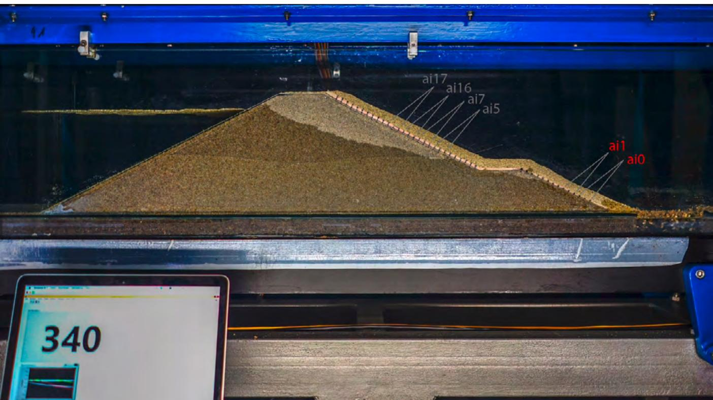
Modellaufbau mit Sensorvlies (Foto: ITA)
