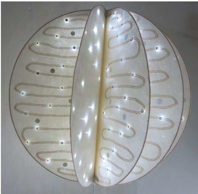
Textile LED-Lampe, die aus zwölf Segmenten mit jeweils 20 LEDs besteht. Durch eine gezielte Verschaltung der LEDs in Verbindung mit einer erhöhten Betriebsspannung lässt sich der Stromfluss von 4,8 A auf 400 mA begrenzen (Foto: TITV)
