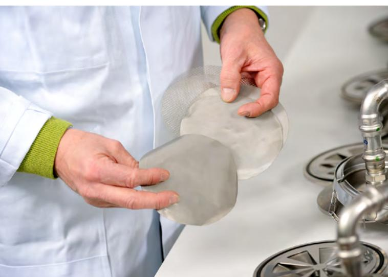
Einsetzen von Drahtgewebe in den Filterprüfstand (oben) und Mikroskopische Untersuchung von Filterrückständen (Fotos: FTB)
