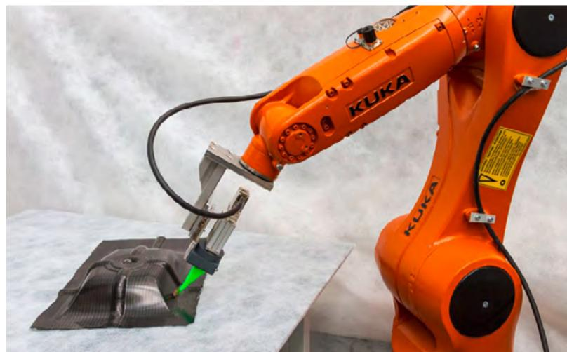
Robotergeführte Wirbelstromprüfung eines komplexen CFK-Bauteils (Federdom) auf korrekte Faserorientierung und Fehlerfreiheit (Foto: ITM/TU Dresden)
