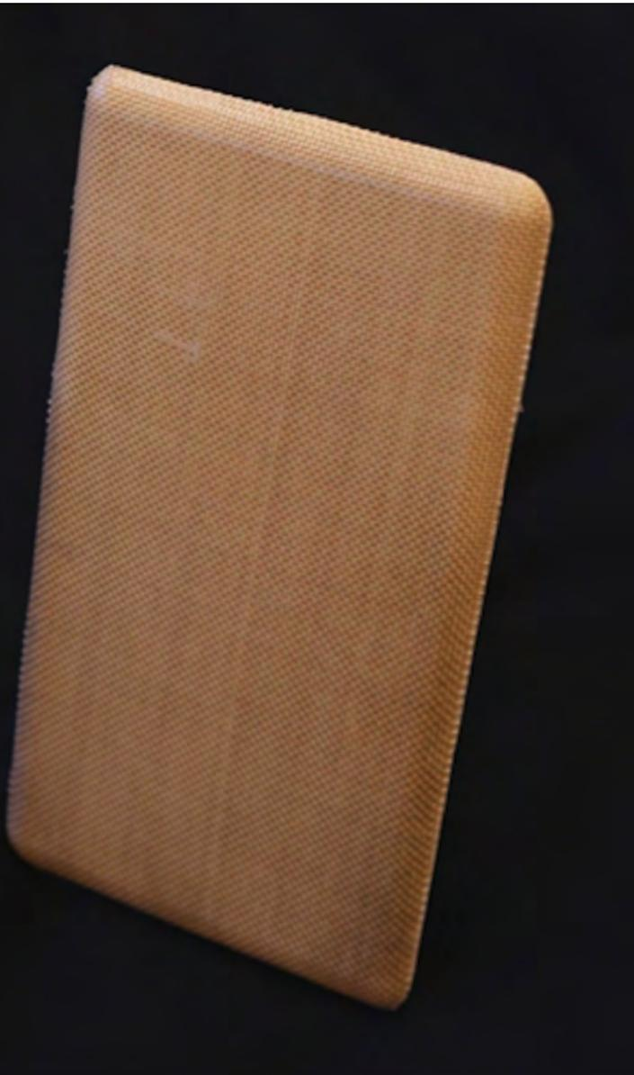
Umgeformte Schale für die rückseitige Verkleidung eines Smartphones aus mit poly-PETA-Dünnschichten versehenem Cordenka®-Gewebe in einer Polypropylenmatrix (Foto: DTNW)
