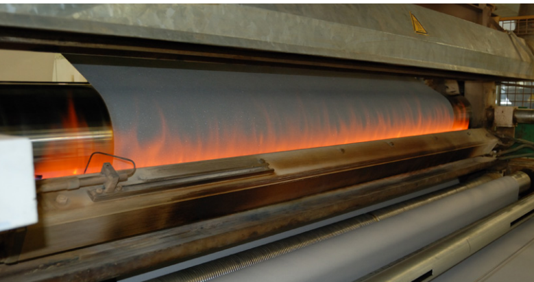
Flammkaschieranlage, mit der die Verbundstoffe mit klebstofffreiem Aufbau gefertigt werden
