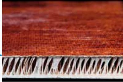
Abstandstextilien – verarbeitet als verharzte Platte – sind ideal geeignet für leichte, funktionelle Tragelemente oder Strukturbauteile mit bedarfsgerechter Steifigkeit.
