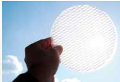
Leicht, flexibel, transluzent und bruchsticher – ein wärmeisolierendes Abstandstextil ist optimal geeignet für viele solarthermische Anwendungen.
